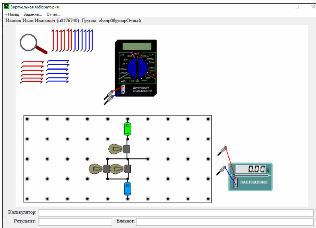
Имеется цепь из соединённых резистора  $R_1$ , резистора  $R_2 = 2 \cdot R_1$  и трех одинаковых лампочек, в которой можно подсоединяться только к внешним клеммам. Сопротивления лампочек не зависят от протекающего через них тока. Напряжение источника можно менять в большом диапазоне с помощью движка и с небольшими шагами с помощью маленьких треугольников по бокам движка.
