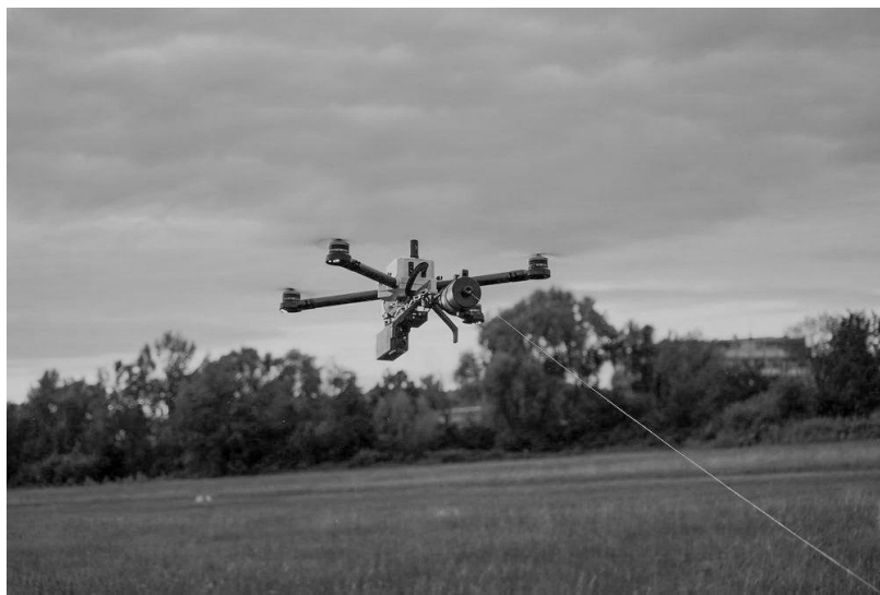
Рис. 2. Квадрокоптер, управляемый по оптоволокну
