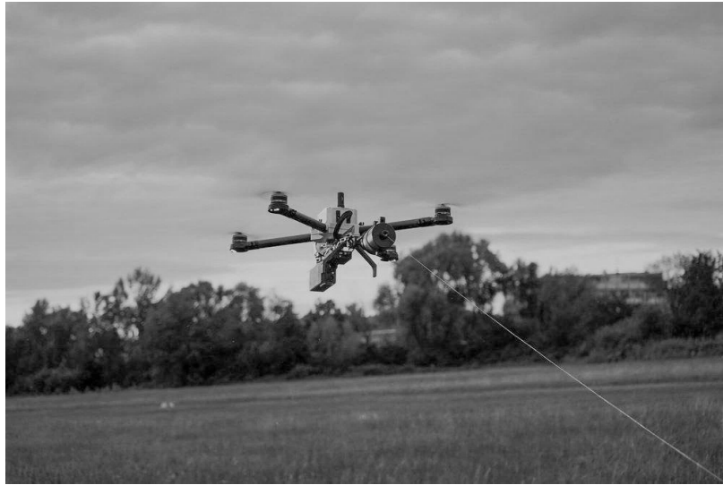
Рис. 2. Квадрокоптер, управляемый по оптоволокну
