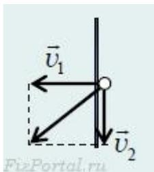
Так как стенка гладкая, вертикальная составляющая скорости шарика в момент удара о стенку не изменится. А поскольку полное время движения тела, брошенного под углом к горизонту, определяется вертикальной проекцией скорости, то время движения  $t$  будет таким же, как и в отсутствие стенки (1 балл)
