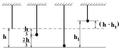
**Резиновый жгут.** После уравновешивания грузика на жгуте выполняется условие:  $mg = k\frac{h}{3}$ . Потенциальная энергия растянутого до пола жгута при его отпускании перейдет в потенциальную энергию грузика:  $\frac{kh^2}{2} = mgh_1$
