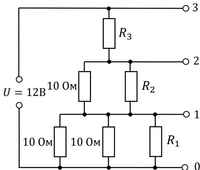
сопротивлений  $R_1, R_2, R_3$  неизвестны, но два из них одинаковы. Найти значения всех неизвестных сопротивлений, если напряжение между точками 0 и 2 равно 6 В, а между 3 и 1 - 10 В.
