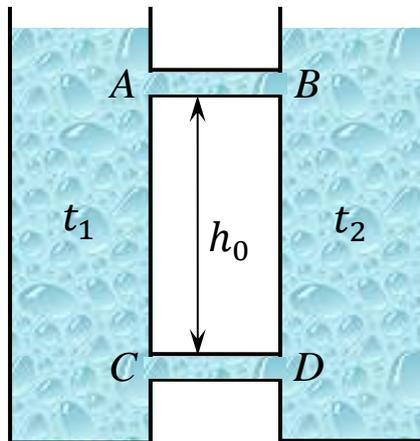
**Решение.** Пусть давления в точках  $A, B, C, D$  равны  $p_A, p_B, p_C, p_D$ , причем, согласно условию  $p_D > p_C$  и  $p_A > p_B$ , что и вызывает циркуляцию воды между цилиндрами. Давления  $p_D, p_B$  и  $p_C, p_A$  связаны между собой как
