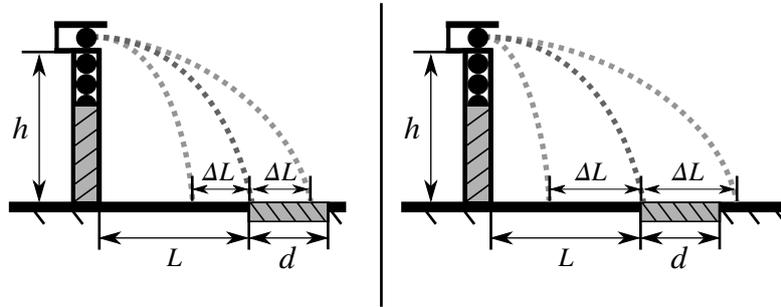
Рис. 3: Случай малого разброса скоростей (слева) и случай большого разброса скоростей (справа).
