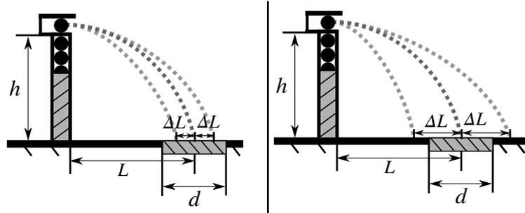
Рис. 3: Случай малого разброса скоростей (слева) и случай большого разброса скоростей (справа).
