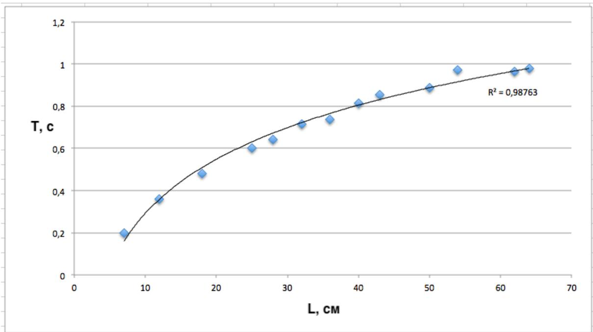
Рисунок 2 – Экспериментальная зависимость периода колебания маятника T от длины резинки L
