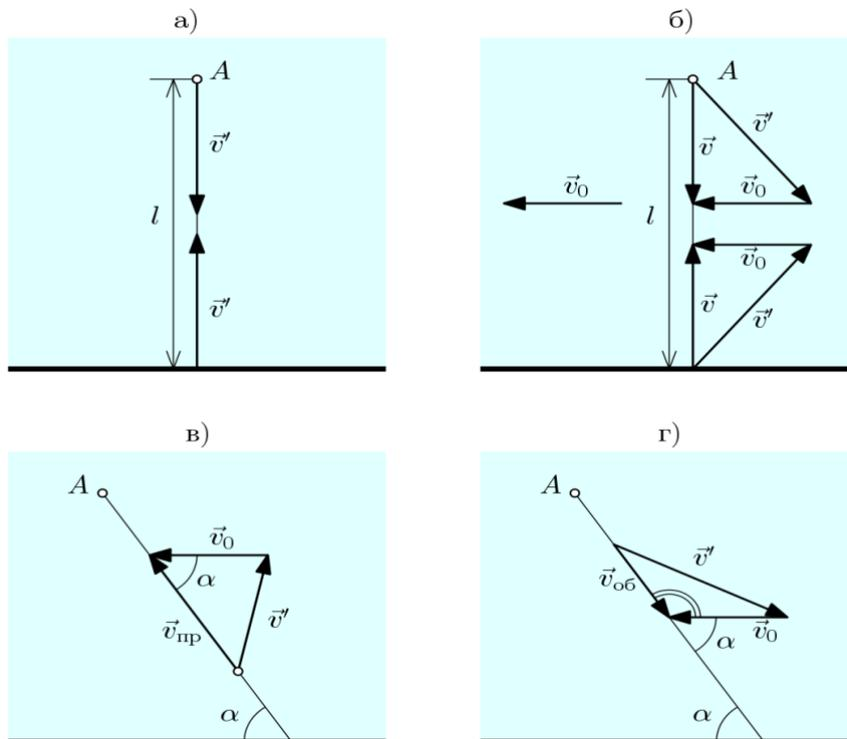
Рисунок: а) движение в озере, б) движение в реке перпендикулярно течению, в, г) движение в реке под углом к течению в прямом и обратном направлении.
