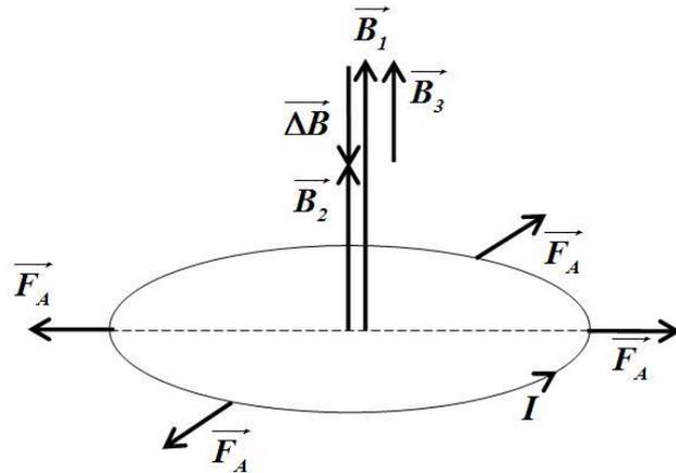
При изменении индукции магнитного поля изменяется магнитный поток, пересекающий контур. Появляется ЭДС индукции, индукционный ток и сила Ампера. Если магнитный поток уменьшается, то индукционный ток направлен так, что сила Ампера направлена от центра контура наружу.
