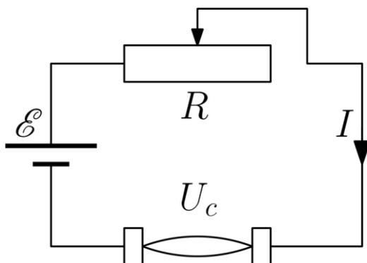
Петя сделал именно вариант с последовательным соединением, поскольку при параллельном соединении, с учетом того, что мы согласно условию пренебрегаем всеми сопротивлениями, кроме реостата, ток в цепи просто не будет зависеть от  $R$ :  $\mathcal{E} = U_c$ .
