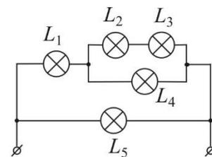
$I_1 = I_2 + I_4$  (нумерация токов соответствует нумерации лампочек). Поэтому лампочка  $L_1$  горит ярче, чем лампочки  $L_2$ ,  $L_3$  и  $L_4$ .
