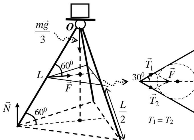
Рассмотрим равновесие моментов сил для ножки относительно шарнирной точки соединения  $O$ . При этом реакция шарнира, вертикальная составляющая которого  $m\vec{g}/3$ , а горизонтальная компенсирует  $\vec{F}$  (на рисунке не указана), имеет момент равный нулю. Тогда, для моментов сил получаем:
