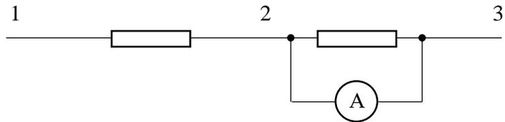
Сопротивление такой схемы вычисляют по формуле:  $R = R_{1,2} + \frac{R_{2,3} \times R_A}{R_{2,3} + R_A} = 14 \text{ Ом}$ ; тогда по закону Ома для участка цепи сила тока в неразветвленной части цепи:  $I = \frac{U}{R} = 0,1 \text{ А}$ . Ток распределяется между резистором и амперметром в соотношении 1/4. Следовательно, через амперметр течёт ток 0,08 А. Это значение силы тока и показывает амперметр.
