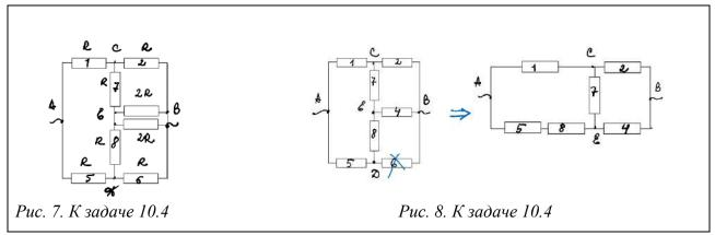
2. Для того чтобы узнать, какой резистор перегорит следующим, после перегорания резистора 6, нужно найти резистор, через который потечет наибольший ток. Изобразим полученную схему (рис. 8). В данном случае можно воспользоваться известным нам преобразованием из треугольника в звезду для резисторов 7, 4 и 2 (рис. 9). Так как резисторы 1 и 5 ничего об этом не «узнают», то напряжения на них сохранятся, соответственно сохранятся и токи, тогда после преобразования легко находятся силы тока:
