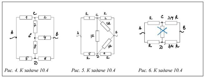
Можно получить тот же результат, не прибегая к преобразованию «звезда — треугольник», а представляя резистор 4 как два параллельно соединенных резистора сопротивлением 2R и разделяя схему на две симметричные части (рис. 7).
