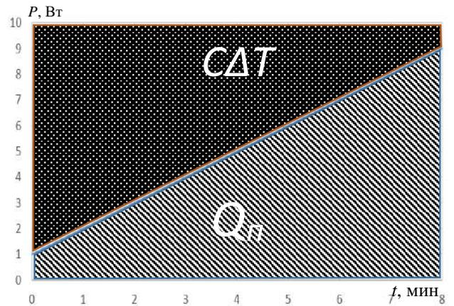
Начальная температура резистора  $40^{\circ}\text{C}$ , максимально допустимая температура резистора  $100^{\circ}\text{C}$ . Теплоёмкость резистора  $40$  Дж/ $^{\circ}\text{C}$ .
