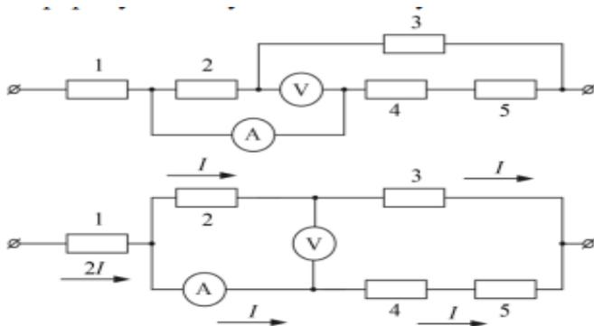
Так как идеальный вольтметр эквивалентен разрыву цепи, а падение напряжения на идеальном амперметре равно 0, то резисторы 2 и 3 параллельны резисторам 4 и 5. Из равенства сопротивлений резисторов следует, что амперметр показывает половину общего тока. Такой же ток бежит через резистор 2, напряжение на котором показывает вольтметр. Значит сопротивление резистора  $R = 3 \text{ Ом}$ .
