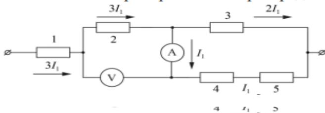
Теперь резисторы 4 и 5 параллельны одному резистору 3, значит ток через них в 2 раза меньше. Через резисторы 1 и 2 бежит общий неразветвленный ток (в 3 раза больший чем через резистор 4), через амперметр ток отводится на ветку 4-5. Общее напряжение не изменилось. Запишем его как сумму падений напряжения на резисторах 1, 2 и 3:
