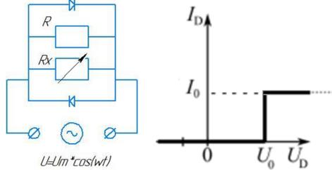
Найти зависимость тока от времени в цепи, если сопротивление элемента X зависит от тока так:  $R_x = \alpha I_x^2$ , а ВАХ диода показана на рисунке. Напряжение на концах цепи меняется по гармоническому закону, а  $U_m = U_0$ ,  $I_0 = \sqrt[3]{\frac{U_0}{\alpha}}$ .
