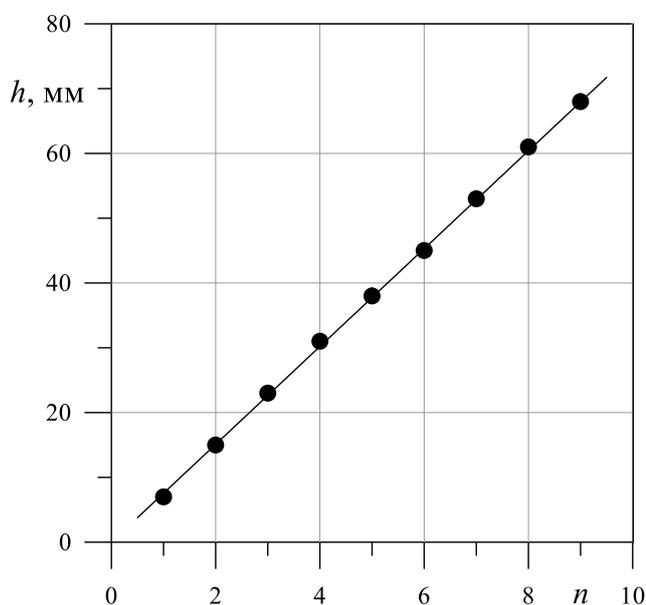
Коэффициент наклона графика равен  $\frac{\Delta h}{\Delta n} = 7.6 \text{ мм}$ . Следовательно, плотность материала шариков равна  $\rho_1 = 8 \cdot 10^3 \text{ кг/м}^3$ .
