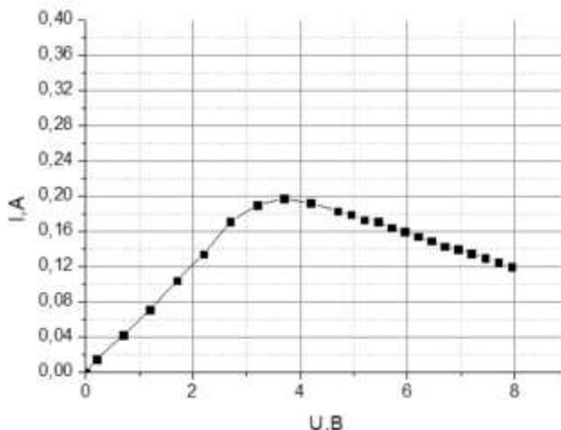
**Вопрос №2:** Какой ток будет протекать через нагреватель спустя длительное время, если его подключить к источнику с напряжением 6 В с последовательно подключенным дополнительным сопротивлением 30 Ом?
