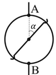
**Возможное решение.** Перерисуем схему цепи, как показано на рисунке, где  $R_1$  и  $R_2$  – сопротивления дуг кольца, соответствующих с центральными углами  $\alpha$  и  $(\pi - \alpha)$  соответственно:
