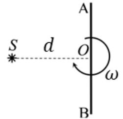
**Возможное решение.** Определим характер движения изображения. Для этого построим изображения точки  $S$  при старом ( $S'$ ) и новом ( $S''$ ) положении зеркала (после поворота на угол  $\alpha$ ). Треугольник  $SOS''$  – равнобедренный. Изображение источника движется по окружности радиусом  $OS'' = d$  с центром в точке  $O$ .
