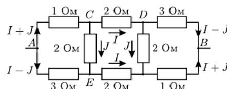
относительно вертикальной и затем горизонтальной осей чертежа. Следовательно, токи, текущие через горизонтально расположенные резисторы с сопротивлениями 2 Ома, одинаковы (обозначим эти токи через  $I$ ). По этой же причине одинаковы токи, текущие через вертикально расположенные резисторы с сопротивлениями 2 Ома (обозначим их через  $J$ ). Тогда распределение токов в схеме будет таким, как показано на рисунке.
