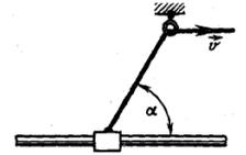
**Возможное решение.** За один и тот же малый промежуток времени  $\Delta t$  ползун перемещается на  $AB = \Delta l$ , а шнур выбирается на длину  $AC = \Delta l \cos \alpha$  (1).
