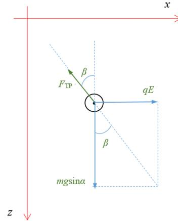
Если  $\mu > \mu_{\min}$  брусок будет оставаться неподвижным, а значит из условия равновесия и геометрии рисунка  $F_{\text{тр}} = \sqrt{(qE)^2 + (mg\sin\alpha)^2}$  и  $\text{tg}\beta = \frac{qE}{mg\sin\alpha}$ . С учётом того, что  $F_{\text{тр}} \leq \mu mg\cos\alpha$ , находим  $\mu_{\min} = \frac{\sqrt{(qE)^2 + (mg\sin\alpha)^2}}{mg\cos\alpha}$ .
