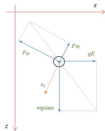
$$\sqrt{(qE)^2 + (mg\sin\alpha)^2} = \sqrt{(qv_y B)^2 + (\mu mg\cos\alpha)^2}, \text{ откуда } v_y = \frac{\sqrt{(qE)^2 + (mg\sin\alpha)^2} - \mu mg\cos\alpha}{qB}.$$
