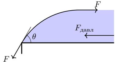
2. Если поставить на ртуть цилиндр массой  $m$ , то в каждой точке жидкости гидростатическое давление возрастёт на величину  $mg/S_{\text{к}}$ , где  $S_{\text{к}}$  — площадь контакта ртути и поставленного на неё цилиндра. Среднее гидростатическое давление в слое ртути в этом случае составит
