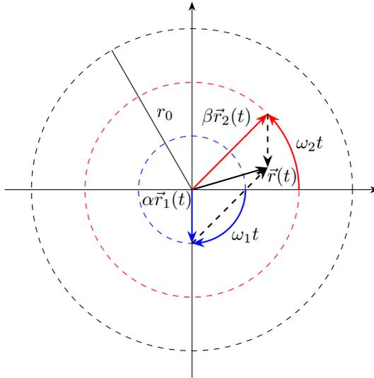
2. Пусть теперь  $\vec{r}_1(t)$  – закон движения бусинки, вращающийся по окружности радиуса  $r_0$  по часовой стрелке, а  $\vec{r}_2(t)$  – закон движения бусинки, вращающийся по той окружности против часовой стрелки. Модули скоростей движения у бусинки при этих движениях различаются: легко найти, что  $|\vec{v}_1| = \omega_1 r_0$ , а  $|\vec{v}_2| = \omega_2 r_0$ . Если записать *суперпозицию* этих законов движения в виде
