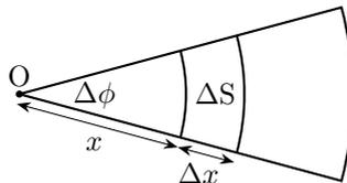
Найдем  $\lambda(x)$ . Выразим заряд на малой площади треугольника, получающегося при дополнении трапеции.
