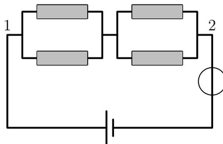
Поскольку резисторы одинаковые, то обозначая их сопротивление через  $R$ , получим, что сопротивление каждого элемента равно  $R/2$ . В итоге, полное сопротивление
