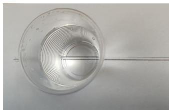
При небольшом отклонении Вы увидите смещение линий под водой. Вам необходимо найти такое положение, при котором линии смещаются на величину  $x = 2$  мм. При этом две линии под водой являются продолжением двух линий, наблюдаемых без воды (см. фото справа). Для определения величины смещения  $h$  воспользуйтесь подобием треугольников  $ABC$  и  $ADE$  (см. рисунок). Определить положение точек  $E$  и  $D$  Вам поможет уголок из картона, вершина  $D$  которого должна попасть на прямую  $AB$ .
