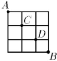
Определите сопротивление каркаса между контактами А и В. Чему равно сопротивление между контактами С и D?
