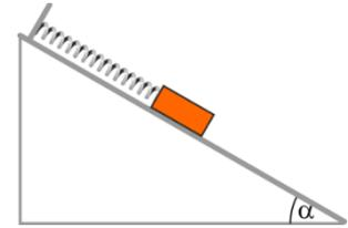
В начальный момент брусок удерживают в положении, при котором пружина не деформирована. Когда брусок отпускают без начальной скорости, он движется в одном направлении и останавливается. При каком минимальном значении коэффициента трения  $\mu_{\min}$  между грузом и плоскостью такое движение бруска возможно?
