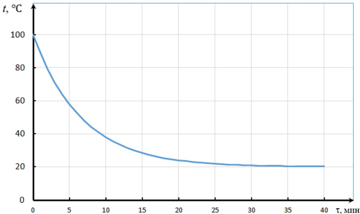
По графику определили температуру  $t_0$  воздуха в лаборатории  $t_0 = 20^\circ\text{C}$ .
