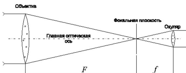
**Задание №3 “Труба Кеплера”** Вам дана схема классического телескопа рефрактора и формула увеличения  $\Gamma = \frac{F}{f} = \frac{D}{d}$ , D - диаметр телескопа (входного пучка), F - фокус объектива, f - фокус окуляра, D - диаметр входного пучка, d -
