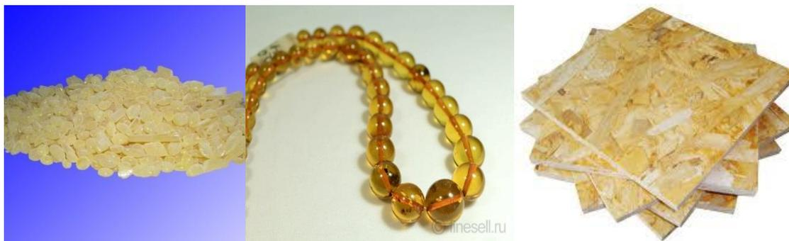
Она используется в качестве связующего компонента для изготовления композиций с различными наполнителями: применяется для изготовления фанеры, древесно-волоконных и древесно-стружечных плит. Из отвержденной фенолформальдегидной смолы (резита) изготавливают эскалаторы в метро, корпуса телефонов, радиоприемников и других приборов, электрические вилки, розетки, выключатели, шашки, шахматы, украшения и т.п.
