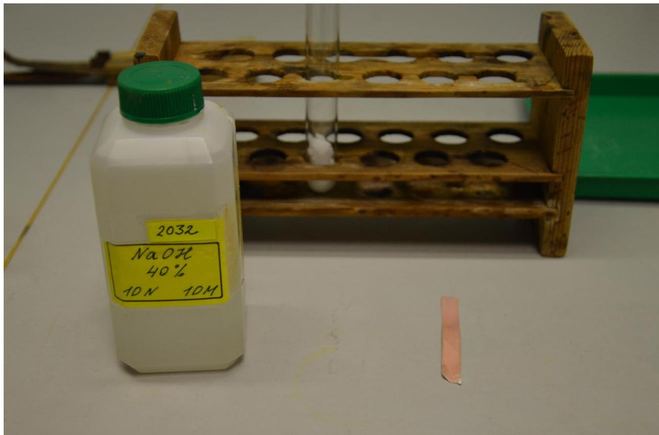
Часть порошка обработали концентрированным раствором гидроксида натрия и поднесли к отверстию пробирки красную лакмусовую бумажку.
