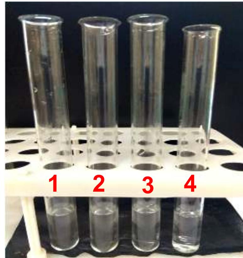
В четыре чистые пробирки отобрали пробы определяемых растворов, после чего добавили к ним бромную воду. В пробирках **3** и **4** наблюдали обесцвечивание бромной воды, в пробирке **1** – выпадение белого осадка.
