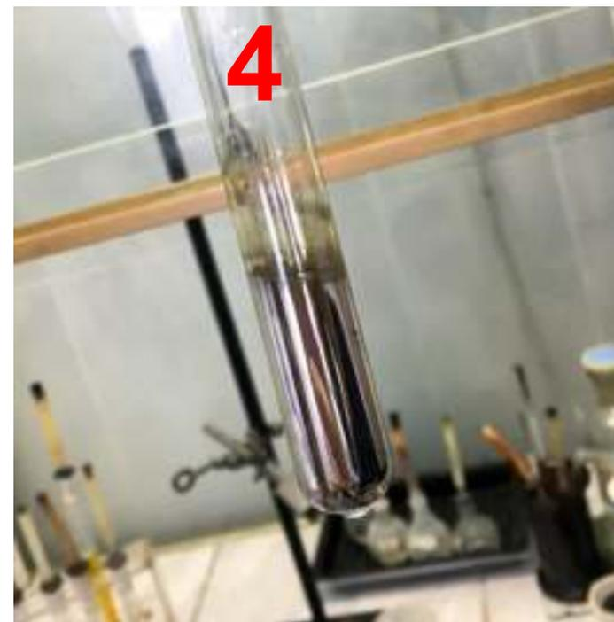
Заново отобрали пробы определяемых растворов **1** и **4**, после чего добавили к ним свежеприготовленный гидроксид меди (II). В пробирке **4** произошло растворение гидроксида меди (II) и образование тёмно-синего раствора, в пробирке **1** изменений не произошло.
