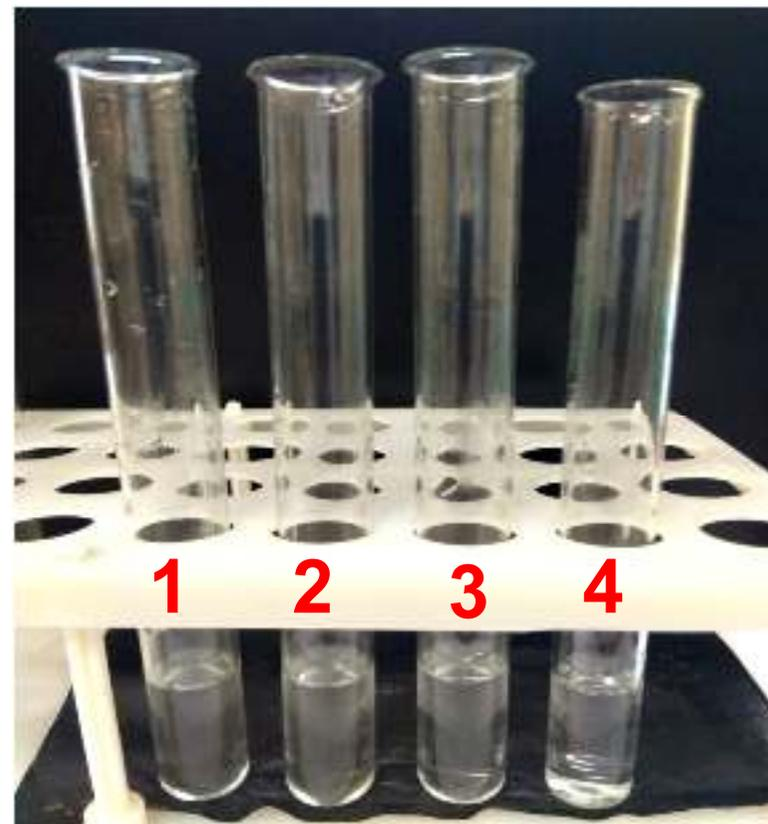
В четыре пробирки отобрали аликвоты определяемых растворов и добавили к ним реактив Толленса. В пробирках **1** и **4** наблюдали образование блестящего налёта на стенках пробирок, в пробирке **3** – выпадение белого осадка. В пробирке **2** изменений не произошло.
