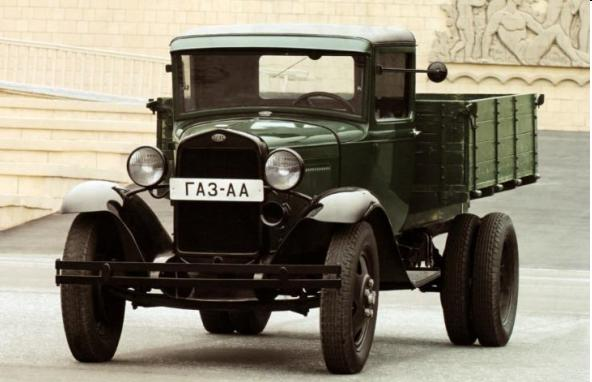
ГАЗ-АА (ГАЗ-11) — советский грузовой автомобиль, выпускавшийся с 1933 по 1941 год. Был создан на основе американского Ford Model A. Автомобиль имел кабину с откидным бортом и был оснащен двигателем мощностью 25 л.с. и четырехступенчатой коробкой передач.                                                        | Горький                 |
