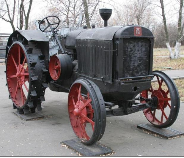
Трактор ДТ (Дальний Трактор) — первый советский трактор, выпускавшийся с 1933 по 1941 год. Был создан на основе английской модели «Fiat-Orbis». Трактор имел мощность 30 л.с. и был оснащен четырехцилиндровым двигателем и четырехступенчатой коробкой передач.                                                     | Сталинград              |
