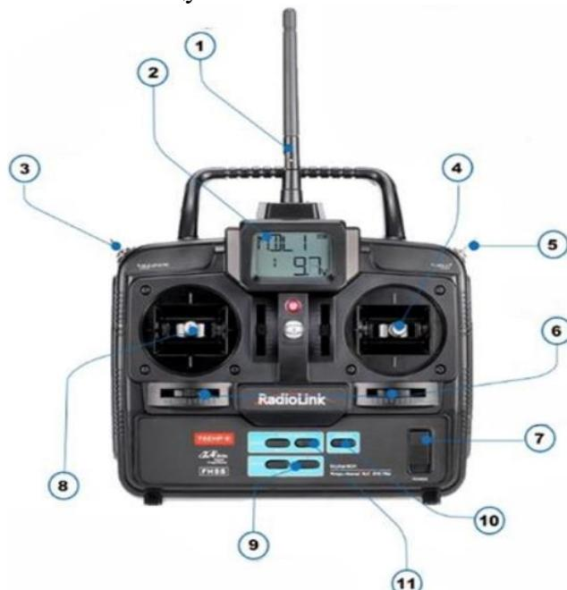
*Варианты: Экран управления, Антенна, Ручка управления, Управление скоростью движением вперёд/назад (тангаж) и влево/вправо (крен), Флип (поворот на 360, Вкл./Выкл., Ручка управления оборотами двигателя и разворот вокруг своей оси (рысканье), Переключатель режимов, Кнопка выбора, Кнопка введения данных, Триммер.*
