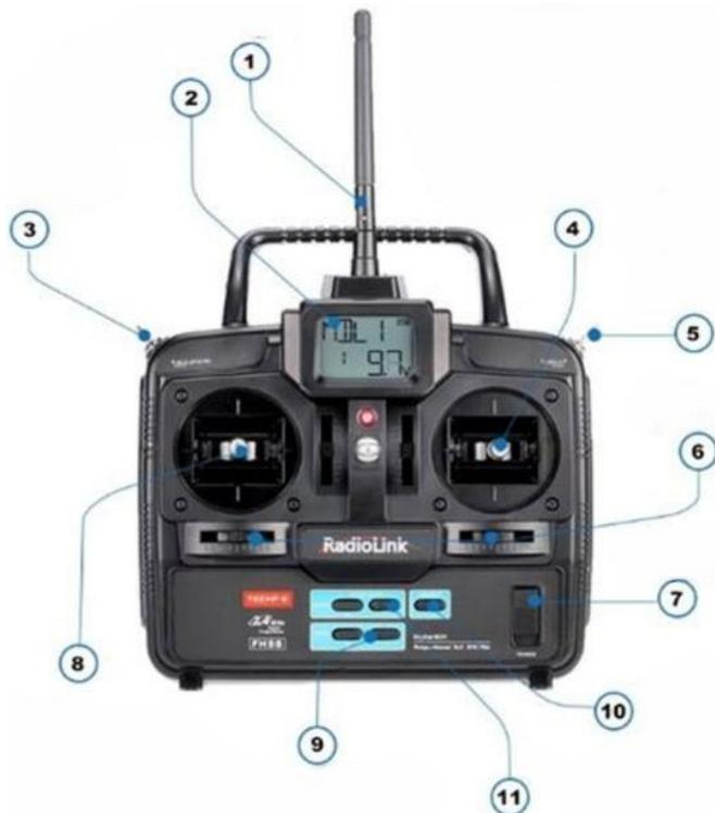
*Варианты: Экран управления, Антенна, Ручка управления, Управление скоростью движением вперёд/назад (тангаж) и влево/вправо (крен), Флип (поворот на 360, Вкл./Выкл., Ручка управления оборотами двигателя и разворот вокруг своей оси (рысканье), Переключатель режимов, Кнопка выбора, Кнопка введения данных, Триммер.*
