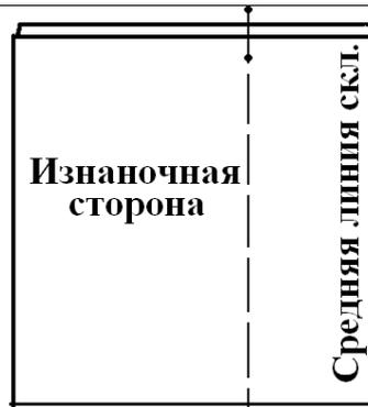
3. Складку разложить на две стороны так, чтобы средняя линия складки совместилась с линией смётывания. Приутюжить с изнаночной стороны детали
