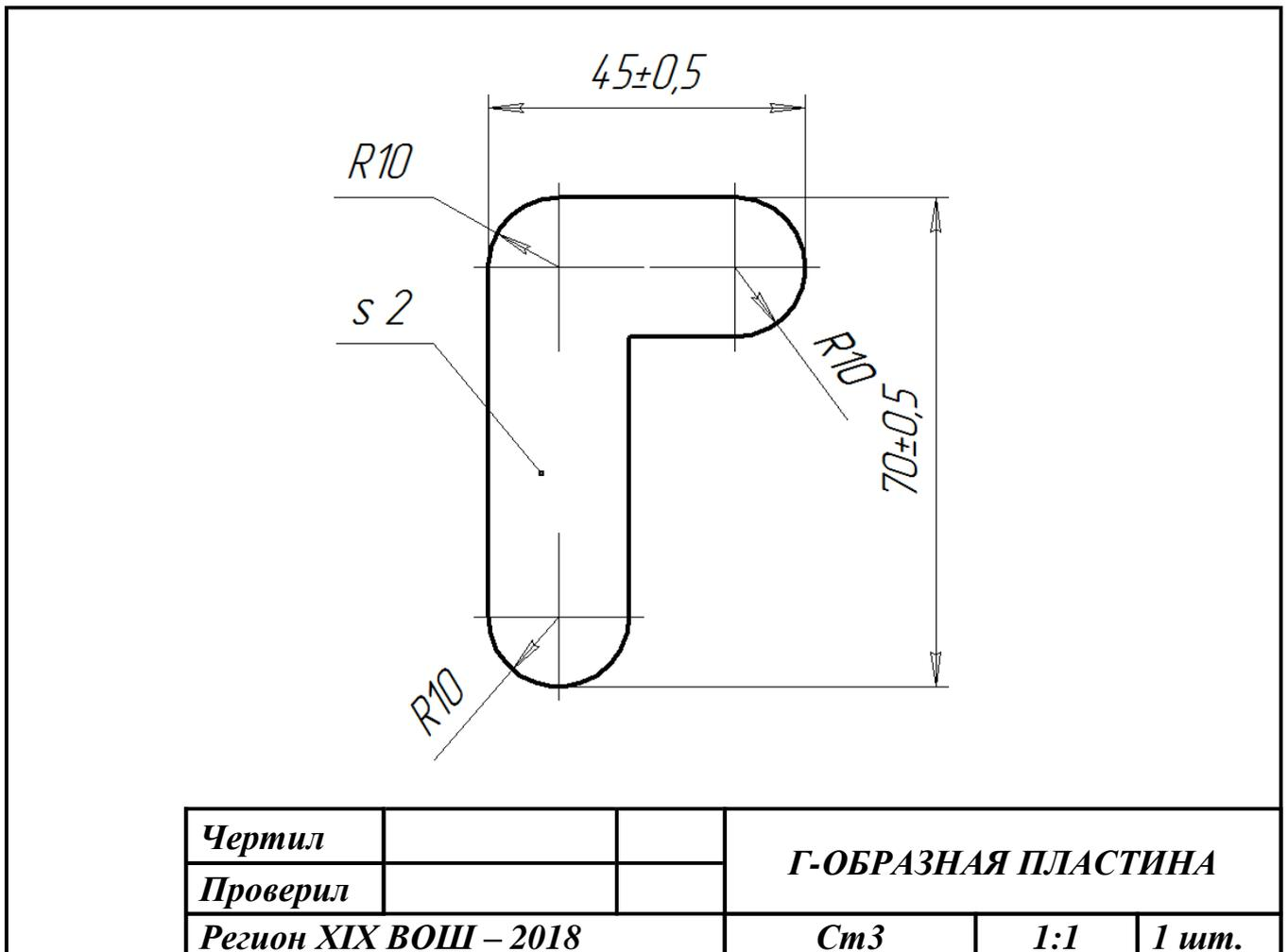
Рис. 1. Чертеж г-образной крепежной пластины
