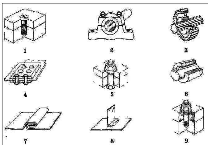
а – болтовое, б – шпоночное, в – винтовое, г – шлицевое, д - вал в подшипнике, е – шпилечное, ж – заклепочное, з – фальцем, и – пайкой.
