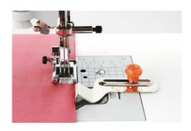
Ответ: ограничитель шва. Приспособление используется для получения аккуратных строчек, идеально параллельных выбранному краю или намеченной линии.
