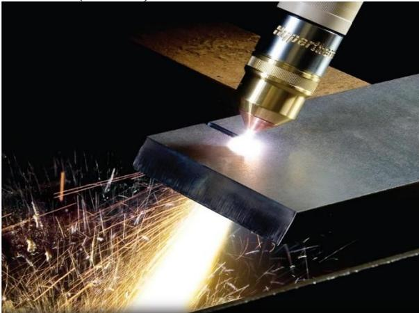
**Ответ: Плазменная резка.**
