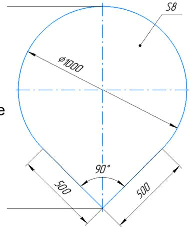
**Вопрос 2. Серёжа выпилил из фанеры деталь.** Толщина фанеры, из которой выпилена деталь, равна 8 мм. На чертеже размеры указаны в миллиметрах. При расчётах примите, что число Пи = 3,14. Плотность фанеры равна 700 г/дм<sup>3</sup>.
