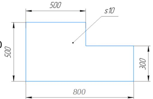
**Вопрос 2.** Серёжа выпилил из фанеры деталь. Толщина фанеры, из которой выпилена деталь, равна 10 мм. На чертеже размеры указаны в миллиметрах. Плотность фанеры равна 725 г/дм<sup>3</sup>.
