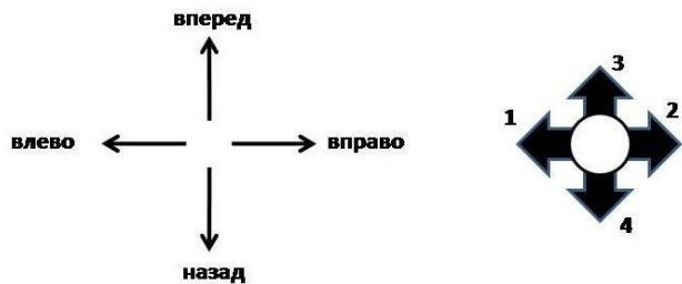
«GUSAR-1» одновременно может выполнять только одно из четырех возможных действий. В зависимости от того, какое положение на пульте управления будет занимать джойстик, робот будет выполнять определенные действия (смотрите Таблицу №1).,
