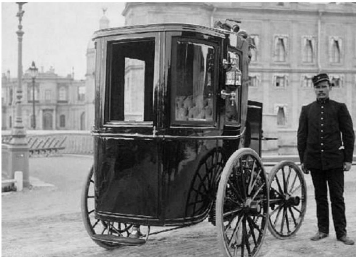
В 1889 году он разработал двухместный автомобиль с внутренним обогревом. В движение автомобиль приводился оригинальными двигателями, которые располагались позади пассажирского салона и с помощью цепной передачи вращали передние колёса. В автомобиле был применён отдельный привод ведущих колёс: каждое из них приводил в движение отдельный двигатель. При этом максимальный запас хода составлял 60 вёрст.
