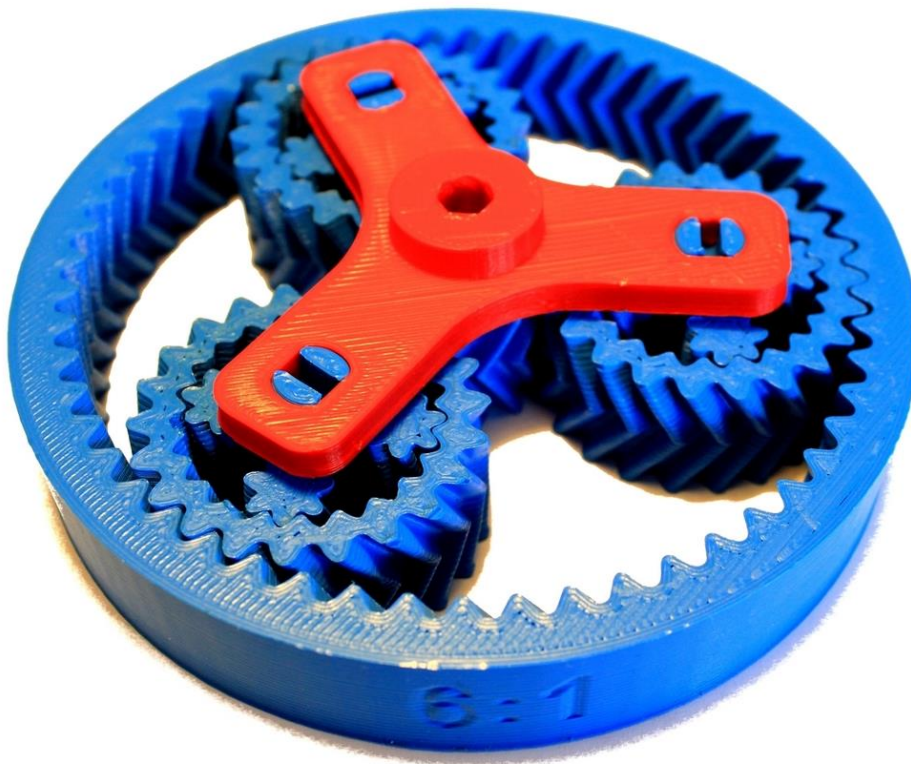
Рис. 3 Пример планетарного механизма
