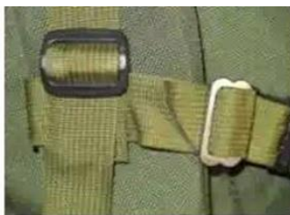
Рис. 2. Пряжка двухщелевая, для крепления и регулирования длины ремней туристического снаряжения
