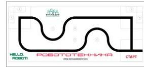
Вариант 2 Допускается изготовление полигона из склеенных между собой листов А4 с распечатанным рисунком поля. При этом обязательно подрезать и проклеить края листов таким образом, чтобы рисунок чёрной линии был без разрывов, края бумаги не должны загибаться.
