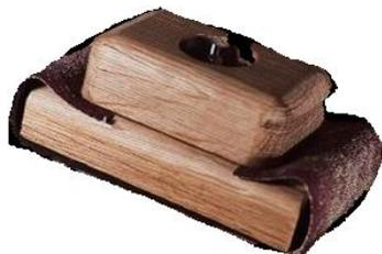
Рис.1 «Приспособление для полировки с удобной ручкой (без сборки на винте)»
