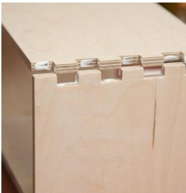
Рис. 1. Соединение боковых стенок декоративной коробочки
