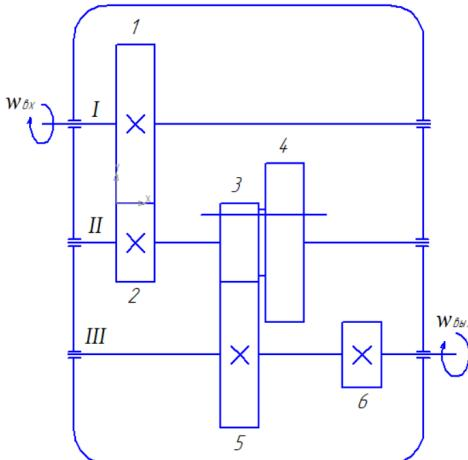
1. Определите  $W_{\text{вых}1}, W_{\text{вых}2}$ .
