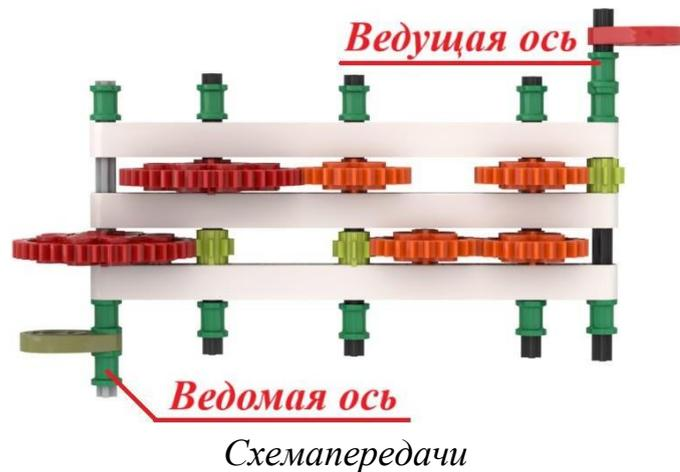
При сборке передачи были использованы три шестерёнки с 8 зубьями, четыре шестерёнки с 24 зубьями и две шестерёнки с 40 зубьями. Ведущая ось совершает 6 оборотов за 12 секунд. Определите, сколько оборотов совершит ведомая ось за 5 минут.
